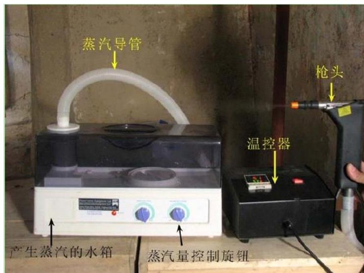
图4-5 脱盐用超声水蒸气雾化器样式
