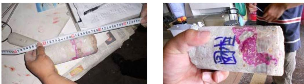
图 4-5 a&b 混凝土碳化检测
