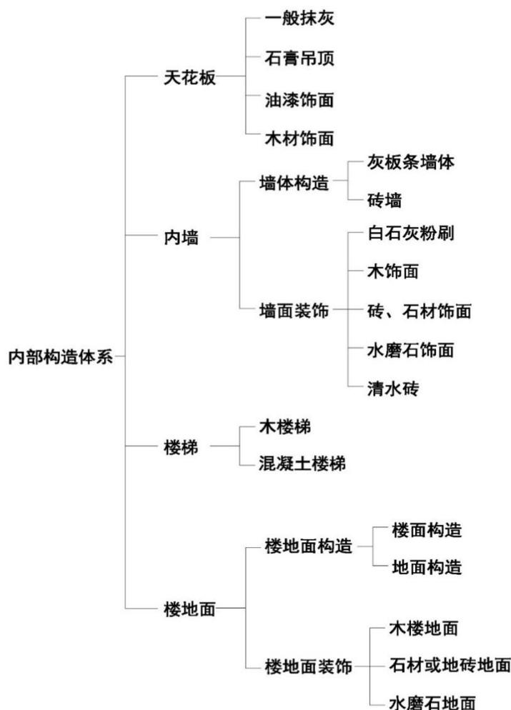
图 6-1 钢筋混凝土体系内部构造分类
